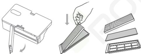
3. Leeren Sie den Staubbehälter. Säubern Sie den Behälter mit der Reinigungsbürste, richten Sie den Filter richtig aus und setzen Sie ihn wieder ein.
