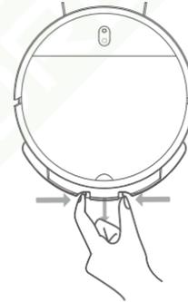
2. Ziehen Sie den Wischer vom Klettband des Wischerhalters ab und schieben Sie ihn aus der Nut (siehe Abbildung). Reinigen Sie den Wischer mit Wasser und bringen Sie ihn wieder an, wenn er vollständig trocken ist. Es wird empfohlen, den Wischer alle 3-6 Monate oder beim merklichen Verschleiß des Wischers zu ersetzen.
