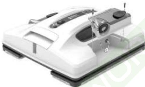
4. Trennen Sie das Sprühdüsen-Anschlusskabel an der Steckverbindung im Kabel vom Fensterputzroboter.
