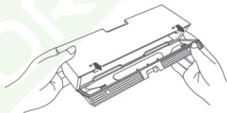
2. Geben Sie sauberes Wasser in den Staubbehälter und schließen Sie den Deckel. Schütteln Sie dann den Behälter hin und her und gießen Sie das Wasser schließlich aus.
