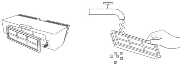
4. Legen Sie den Staubbehälter und den Filter zum Trocknen zur Seite, bevor Sie wieder eingesetzt werden.
