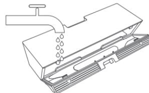
3. Nehmen Sie den Filter heraus, wie in der Abbildung gezeigt, spülen Sie ihn aus und klopfen Sie leicht auf den Rand des Filters, um Staub und Ablagerungen zu entfernen.
