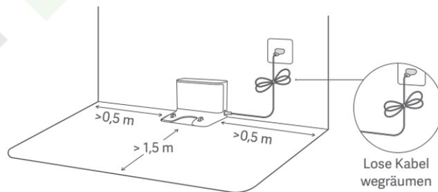
**Hinweis:** Achten Sie darauf, dass sich die Ladestation in einem gut beleuchteten Bereich ohne direkte Sonneneinstrahlung und nicht in der Nähe reflektierender Objekte wie Spiegel befindet, da diese die Rückkehr des Staubsauger-Wischers zur Ladestation erschweren könnten.
