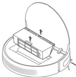
2. Öffnen Sie den Deckel des Staubbehälters wie in der Abbildung dargestellt.
